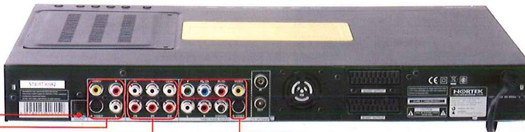
**USCITE DIGITALI** - Sono in totale due, una in standard ottico ed una in standard elettrico coassiale. Criticabile la loro disposizione: la prima isolata su un lato, la seconda posta insieme alle uscite audio/video analogiche.
