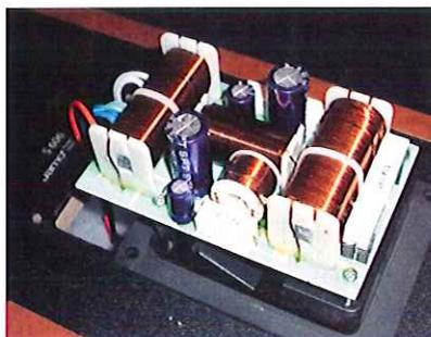
■ **CROSSOVER** - Realizzati con componentistica di qualità e direttamente ancorati alla vaschetta portacontatti, presentano una configurazione a tre vie per i canali frontali e a due per centrale e surround. Le impedenze, avvolte in aria, sono di ottima qualità così come i condensatori; perfetto il layout.
