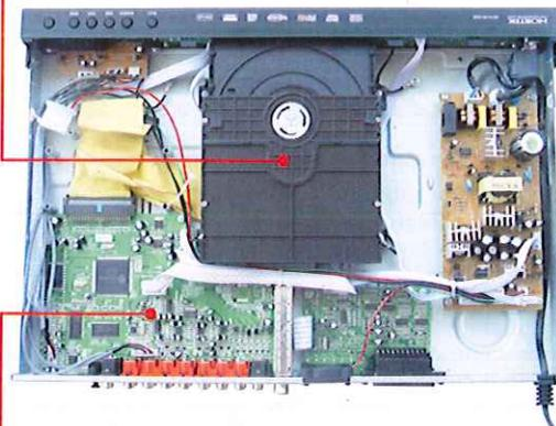
■ **SCHEDA DIGITALE** - Tutto ruota intorno all'integrato SPHE7300 prodotto dalla Sunplus. Un chip capace di effettuare tutte le elaborazioni audio e video creato appositamente per i DVD Recorder. L'integrato in oggetto si occupa di tutte le operazioni di decoding ed encoding relative sia ai formati MPEG video che ai vari stream audio.
