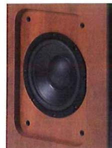
■ **WOOFER** - Le uniche unità a montarne uno sono i canali frontali. Posizionato su un lato lavora in una camera indipendente accordata in reflex con emissione posteriore. Il cono è sufficientemente smorzato ed è realizzato in carta pressata; il tutto è fissato su un cestello non pesantissimo ma sufficientemente rigido.
