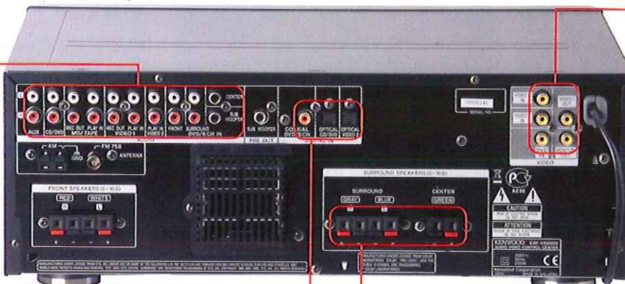
**IN/OUT ANALOGICI** - Le sorgenti audio/video collegabili sono in totale sei, gli ingressi sono disposti in maniera ordinata uno in fila all'altro. Sono presenti due loop di registrazione e non manca l'ingresso 5.1 per il collegamento in analogico di un lettore dotato di decoder interno. L'unica uscita pre messa a disposizione è quella per il subwoofer.
