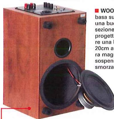
■ **MOBILE** - È realizzato in robusto MDF da 14mm di spessore. L'interno è riempito su tre lati di spugna fonoassorbente mentre il condotto reflex, in plastica, presenta la consueta forma a tubo di venturi.
