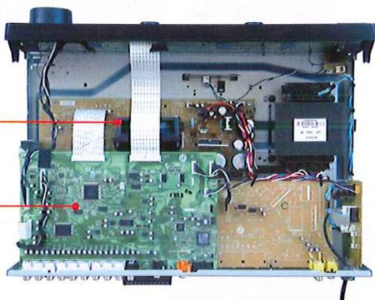
■ **ELABORAZIONE DIGITALE** - La scheda che si occupa dell'elaborazione dei segnali è posta nella parte più alta dell'amplificatore e ne occupa anche una buona parte. La sezione digitale è basata sul famosissimo integrato CS4932 prodotto dalla Crystal al quale si affianca un codec AKM (AK4586) capace di elaborare il segnale dei sei canali con una risoluzione di 96 KHz/24bit.
